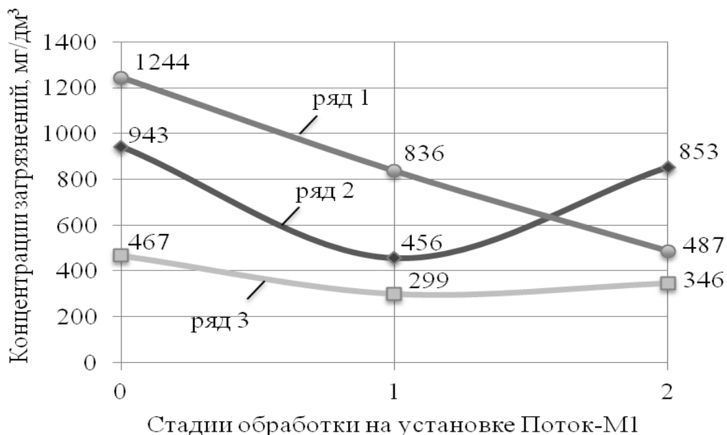
Рис. 2. Изменение концентраций загрязнений в процессе СВЧ-обработки сточных вод: ХПК (ряд 1), взвешенные вещества (ряд 2), БПК 5 (ряд 3)
