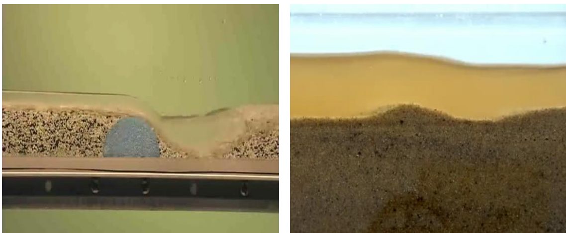
Рис. 2. Отложение наносов на дне лотка
