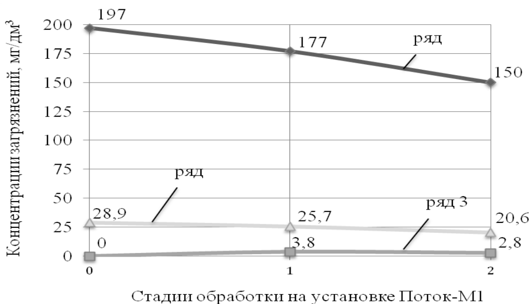
Рис. 3. Изменение концентраций загрязнений в процессе СВЧ-обработки сточных вод: аммоний-ион (ряд 1), фосфат-ион (ряд 2), нитрат-ион (ряд 3)
