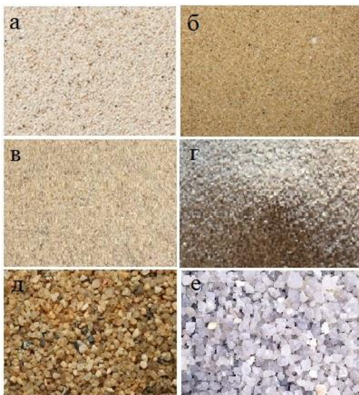
Рис. 1. Снимки кварцевых частиц (подопытный песок) диаметр частиц: а) d = 0,5-0,7 мм; б) d = 0,75-0,95 мм; в) d = 1,0 мм; г) d = 1,0-1,2 мм; д) d = 1,3-2,0 мм; е) d = 2,0-3,5 мм
