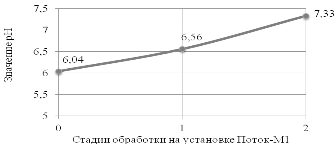
Рис. 4. Изменение показателя активности среды рН после СВЧ-обработки сточных вод
