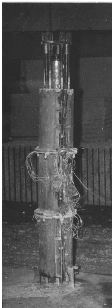
Рис.1. Загальний вигляд колони, зміцненої попереднім обтиском бетону ядра
