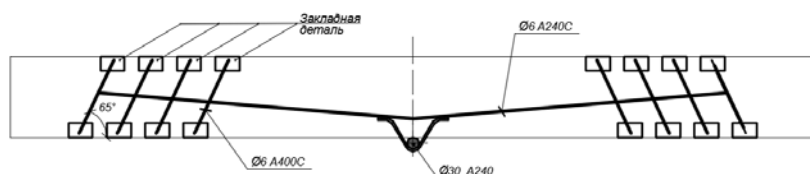
Рис. 1. Схема підсилення балки БПП-ІІ-1 поздовжньою і поперечною паралельно розташованою зовнішньою арматурою
